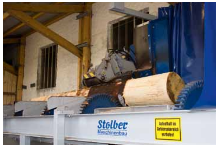
Kombinierte Anlage: Wurzelreduktion und Fräskopfentrindung
