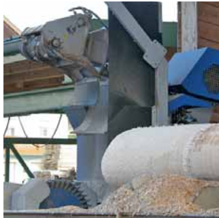
Prototyp im Einsatz: Robust ausgeführter Fräskopfentrindung beim Sägewerk Weilhartner
