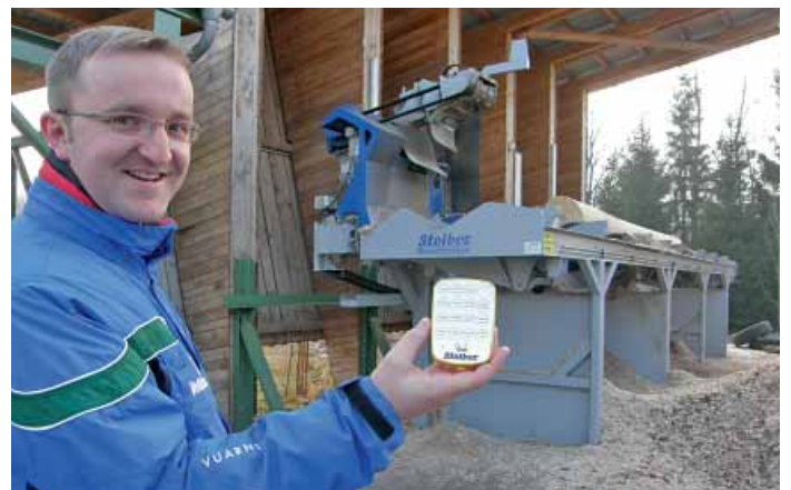
Peter Sexlinger zeigt die Fernbedienung: vom Radlader aus kann die Anlage gesteuert werden
